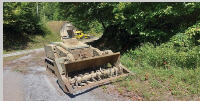
Ukupna površina razminiranja iznosi 71.169 m<sup>2</sup>. Poslovi razminiranja obavljeni su ručnom detekcijom mina, strojevima za uklanjanje vegetacije te psima za pregled površina. Točnije, strojno razminiranje obavljeno je lakisim strojem za razminiranje koji je daljinski upravljan sa sigurne udaljenosti, nakon kojeg je korištena ručna detekcija te detekcija psima.
